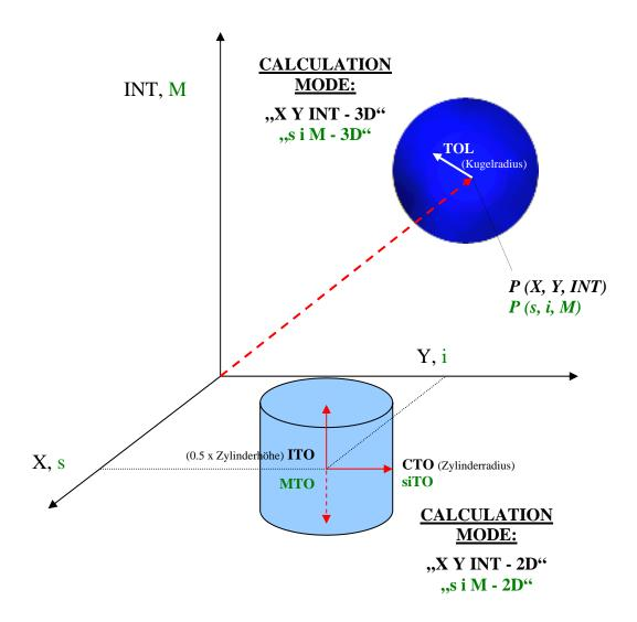
Im Folgenden wird ein Teachvorgang mit dem **EVALUATION MODE = BEST HIT** und dem **CALCULATION MODE = "X Y INT - 3D"** beschrieben.
